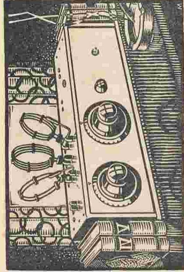
**D**E Erres-toestellen K.I. 3, 4 en 5 zijn kortegolf-toestellen, uitermate geschikt voor het gebruik in de tropen. Het apparaat K.I. 3 is bestemd voor de ultra-korte-golf; het functionneert nog tot op een golflengte van minder dan 5 Meter. Maar ook voor golflengten van 200—3000 M. is het geschikt, althans in Europa. In Indië zal het wel luidspreeker-ontvangst op die golflengten geven van een zwak zendstation, mits in het rayon daarvan.
