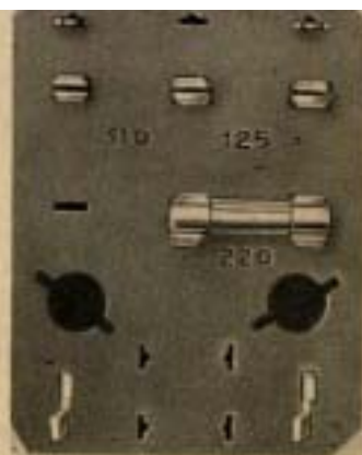
Netzspannungswähler (nach Abnahme der Rückwand zugänglich)
